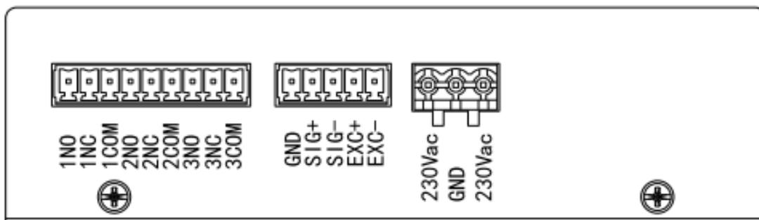
3. Подключить выходы реле к станции управления лифтом.
