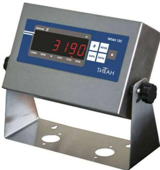
Универсальный весовой прибор для различного вида весов. IP65. 6-ти разрядный LED дисплей (высота цифр 20мм). Класс точности С3. В стандарте: RS232, токовая петля 20mA, встроенная батарея 6V. БЕСПЛАТНОЕ ПО.
