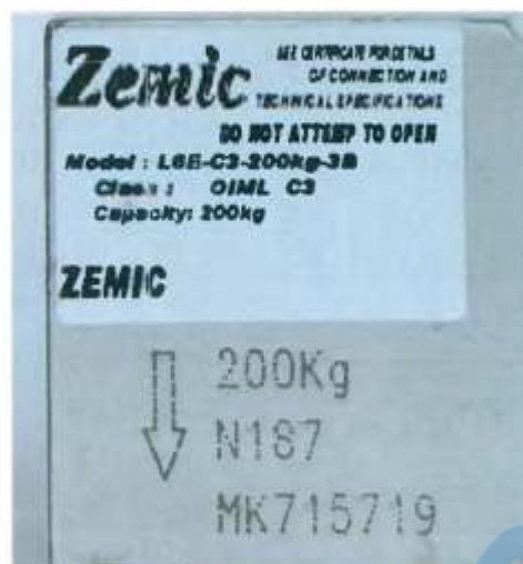
Рисунок 25 – Пример маркировки датчиков
