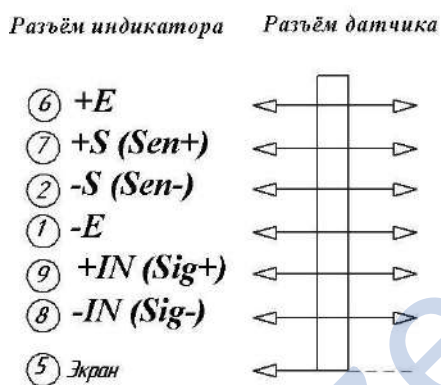
Рисунок 3 – Подключение по 6-ти проводной схеме подключения
